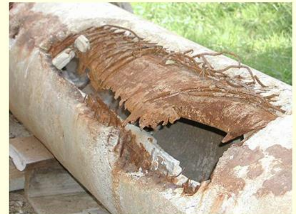
Fig. 1. Dégradation due à l'attaque d'acide sulfurique biogène dans l'espace libre d'une canalisation d'eaux usées
